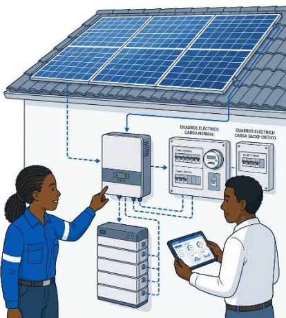
Passo 1: Vista geral da instalação FV com módulos, inversor e quadros eléctricos.
